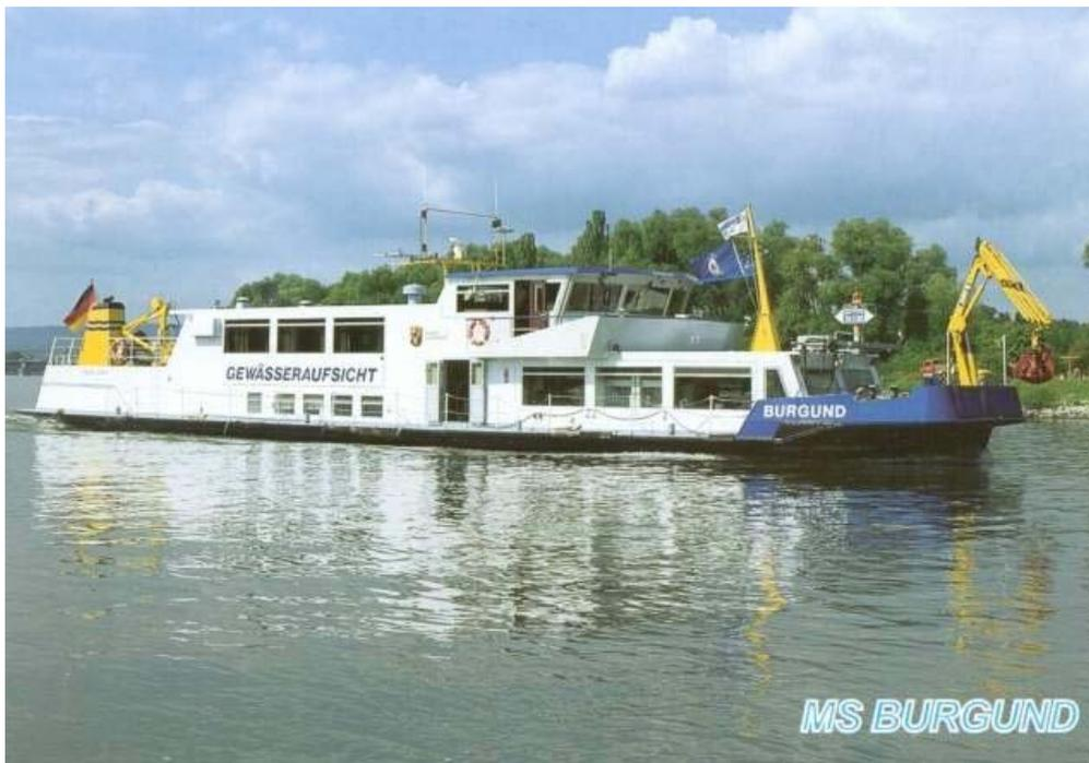
Das Schiff wurde 1988 in Betrieb gestellt. Es ist 35 m lang, 7,30 m breit und mit allen technischen Hilfsmitteln zur Probenahme und zur In-situ-Analytik ausgestattet.
